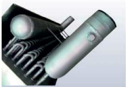
Коллекторы теплообменника – важная часть теплообменника, распределяющего теплоноситель по медным трубкам. На каждом патрубке теплообменника присутствует пробка для слива теплоносителя и продувки теплообменника при консервации на сезон. Важным аспектом является то, что резьба под пробку – трубная, что позволяет вкручивать в них стандартную арматуру (шаровые краны, воздухоотводчики и т.д.)
